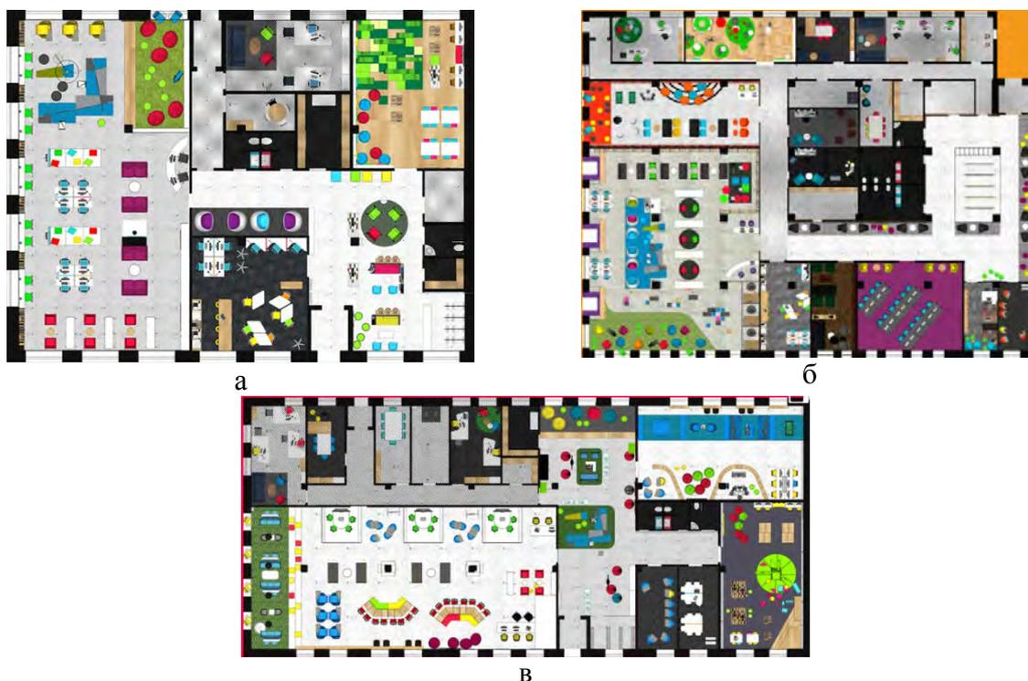
Рис. 4. Модели пространства «библиотек нового типа», архитектурное бюро KIDZ: а – модель 1 (400 м<sup>2</sup>); б – модель 3 (1100 м<sup>2</sup>); в – модель 2, (700 м<sup>2</sup>) библиотека – мультиплекс.
