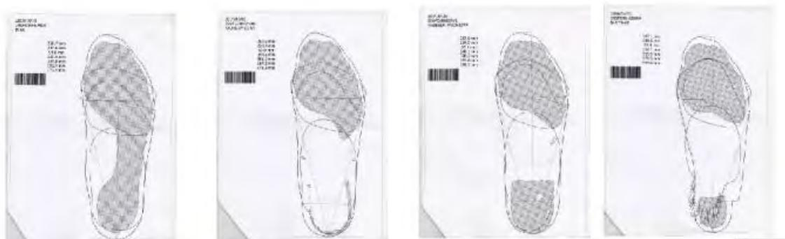
Рис. 1. Отпечатки стопы на плоскости и с подъемом на 10, 25, 60 мм
