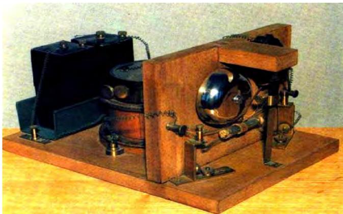
Рис. 2. Внешний вид приемного устройства А. С. Попова, хранящегося в Центральном музее связи им. А. С. Попова
