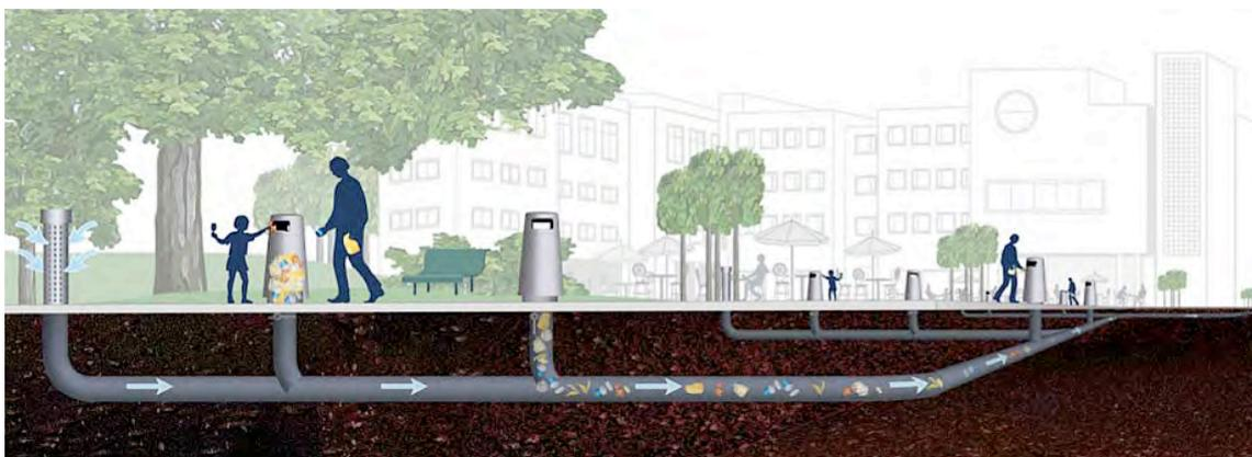
Рис.3. Вакуумная система удаления мусора
