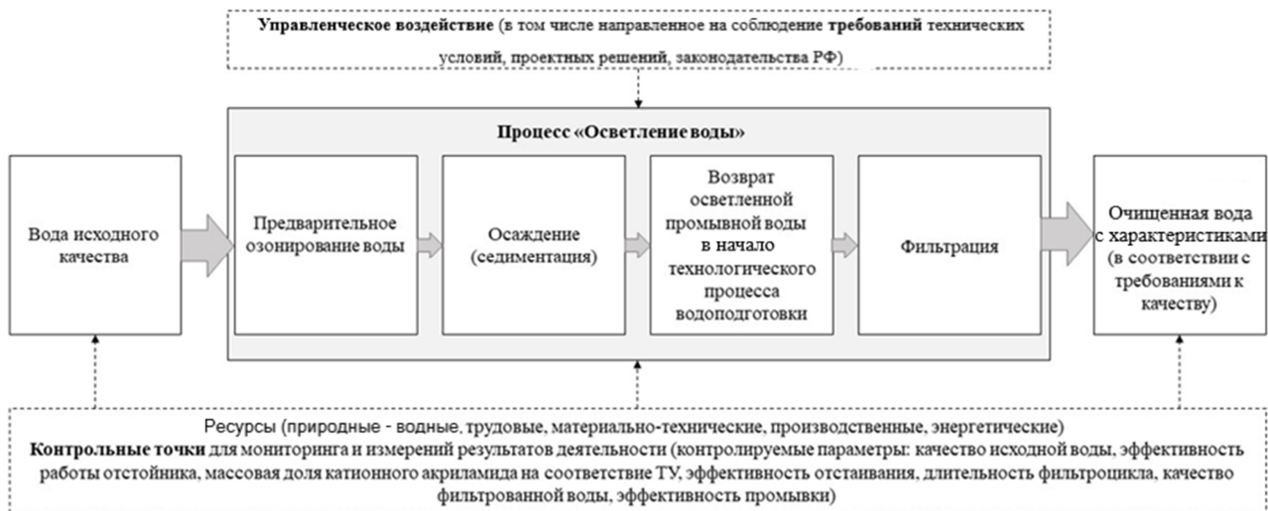
Рис. 1.3. Карта процесса «Осветление воды»
