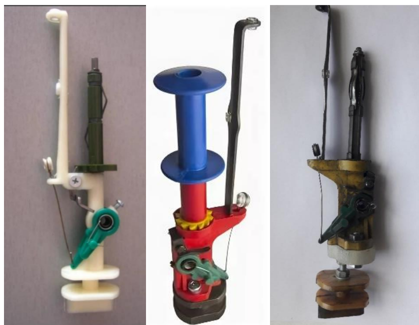
Рис. 57. Плетельные веретена ВПЛ-2 (а), ВПР-125 (б) и доработанное веретено ВПР-125 (в)
