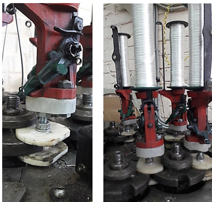
Рис. 58. Веретена ВПР-125 после доработки установленные на плетельную машину ШП 16-3
