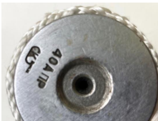
Рис. 60. Шнур ШОАН(К) – 2,5, изогнутый на цилиндре диаметром 40 мм
