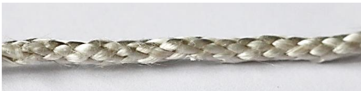
Рис. 59. Фотография шнура марки ШОАН (К) – 2,5 из крученых нитей оксида алюминия
