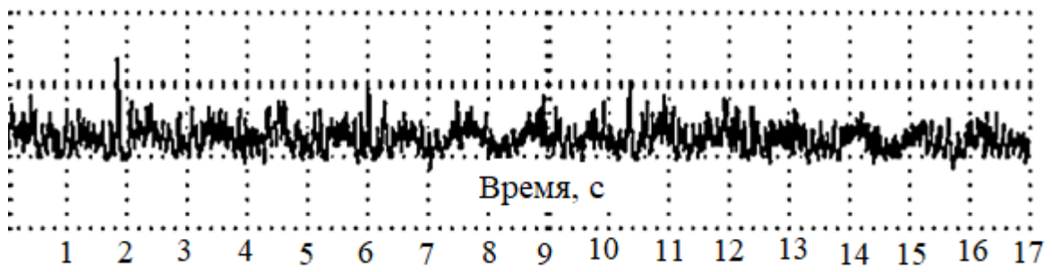
Рис. 48. Осциллограмма выходного напряжения тестера натяжения, скорость нити 7,8 м/мин, масса катушки 0,15 кг
