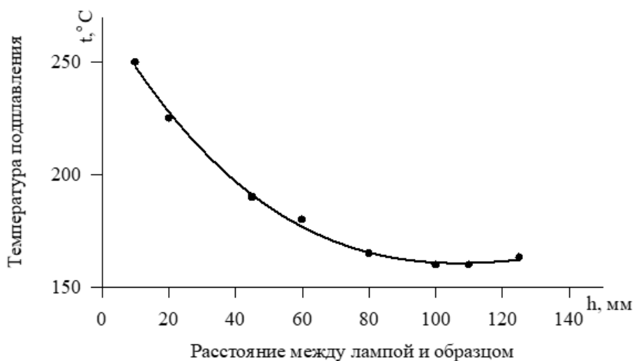
Рис. 2.14. Зависимость температуры от расстояния между лампой и образцом
