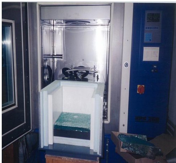
Рис. 2.10. Внешний вид прибора для определения теплопроводности
