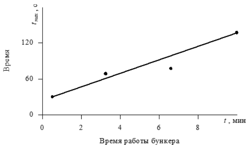
Рис. 6.25. Кинетика достижения максимальной плотности нанесения ворса (кривые слева направо получены по мере истощения ворса в бункере)
