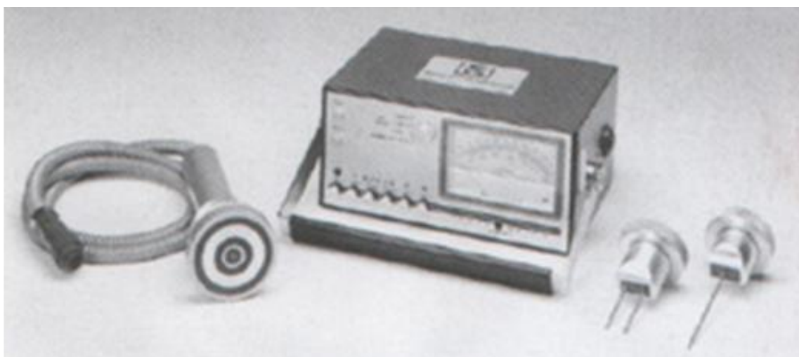
Рис. 2.6. Прибор для измерения электропроводности ворса DMB–6
