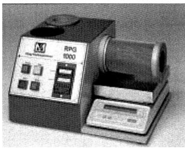
Рис. 2.7. Прибор RPG 1000 для определения разделяемости ворса
