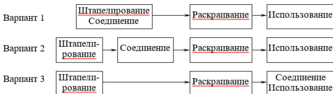
Рис. 6.9. Варианты последовательности операций конфекционирования ТИФМ
