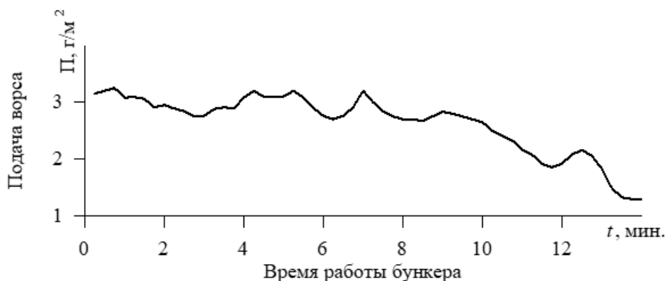
Рис. 6.24. Кинетика подачи ворса в отсутствие электрического поля
