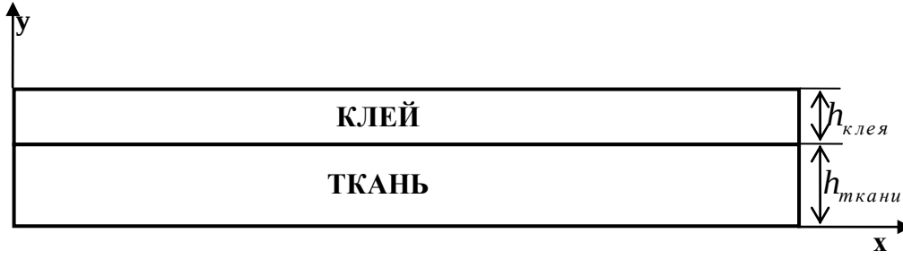
Рис. 5.28. Схема ткани с клеем
