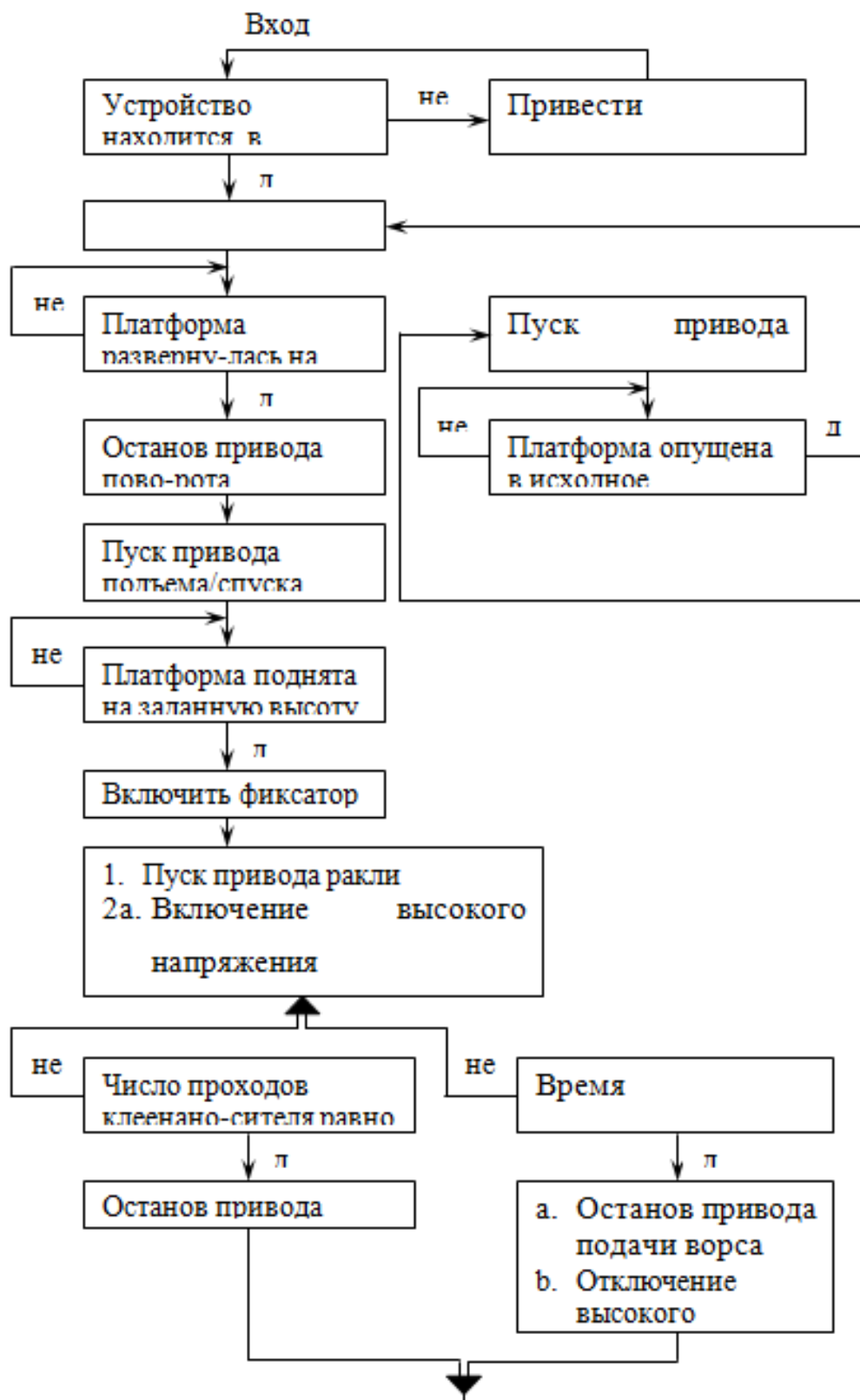
Рис. Н.4. Схема устройства управления установкой УНФ-1
