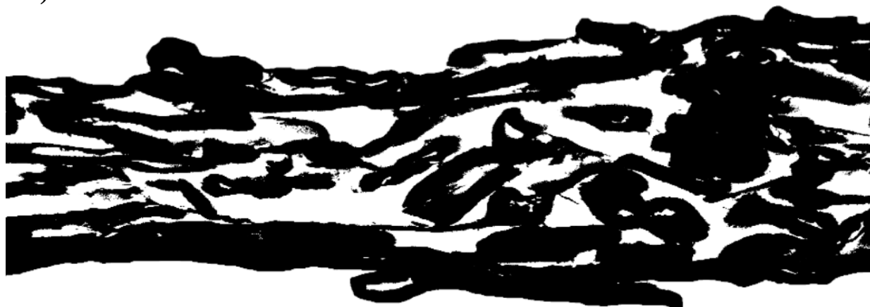
Рис. 6.27. Выделенная область поперечного среза волокнистого материала, переведённая в бинарное изображение
