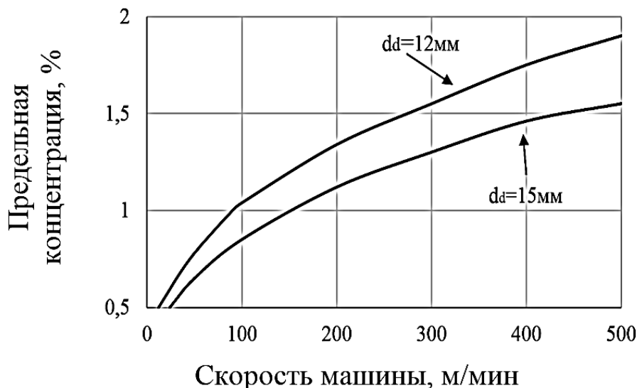
Рис. 5.38. Зависимость предельной концентрации, меньше которой масса, входящая в напускной канал, диспергирована на волокна, от скорости машин при двух значениях диаметра отверстий перфоплиты
