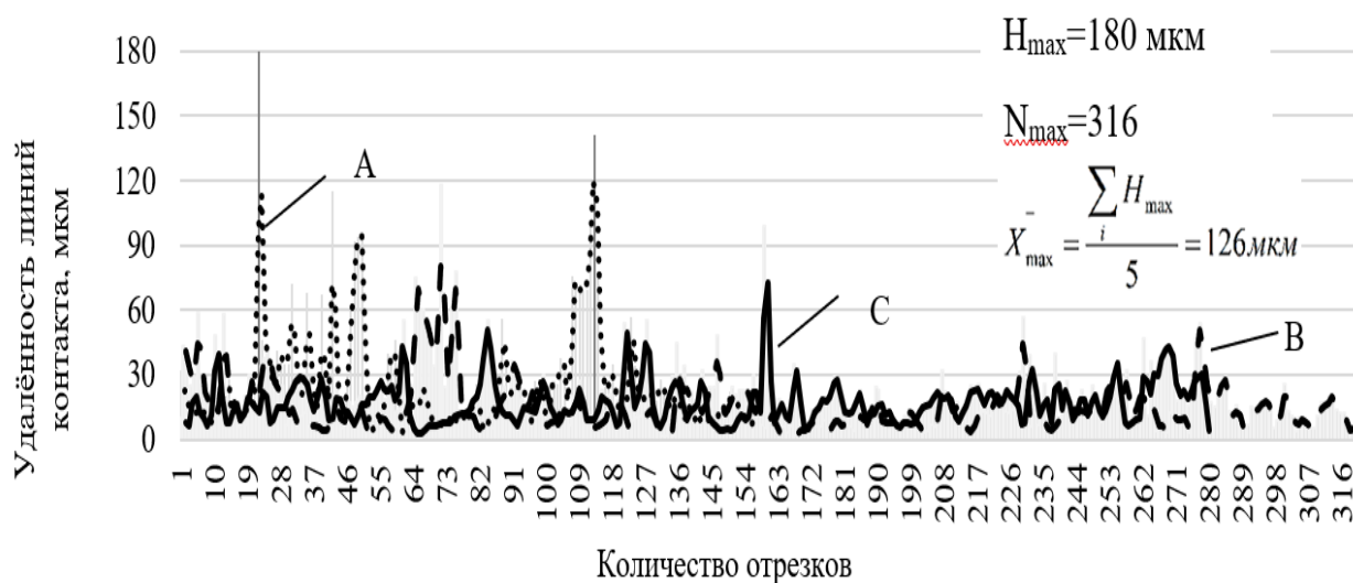
Рис. 6.33. Равномерность распределения линий контакта по площади поперечного среза двухслойного картона: A , B , C – обозначение в соответствии с рис. 6.30
